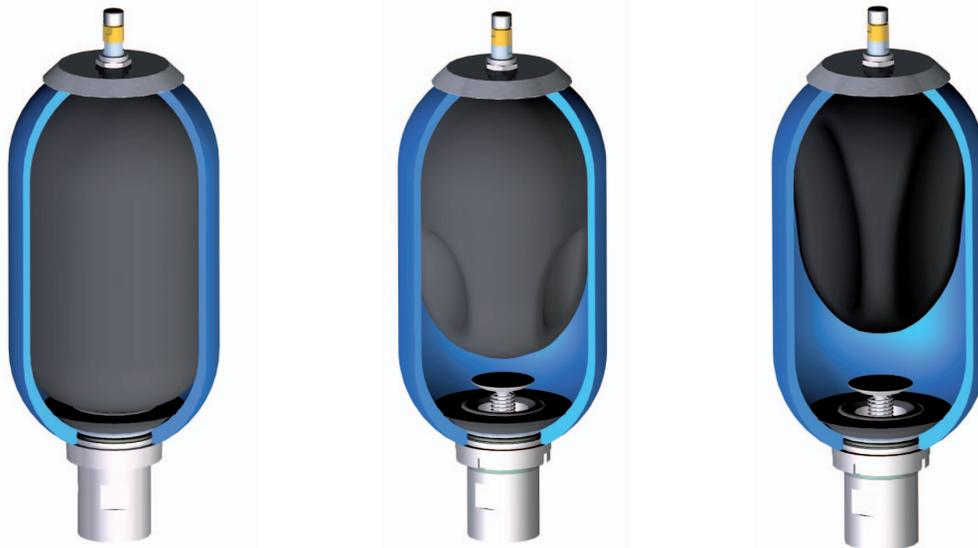
Über das Gasfüllventil wird die Blase mit Stickstoff gefüllt. Sie nimmt die Form des Speicherkörpers an **A**. Wird nun Druckflüssigkeit in den Speicher gefördert, so wird das Gas in der Blase komprimiert. Das Gasvolumen verkleinert sich unter gleichzeitigem Druckanstieg und speichert so die Druckflüssigkeit **C**. Umgekehrt entleert sich der Speicher, sobald der Druck auf der Flüssigkeitsseite tiefer sinkt als der Gasdruck **B**.
