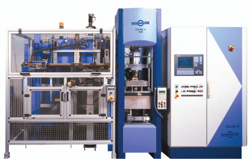
Hydraulische Pulverpresse Typ CANC II 250 mit Voll- automation, mit einer max. Presskraft von 250 kN. Osterwalder AG, Lyss
